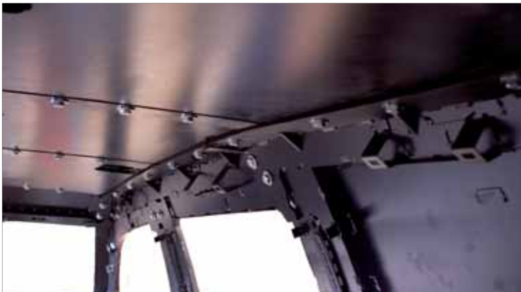
Салон F2-TLC600 полностью собран в виде screw kit так, что хорошо видны болты крепления.
