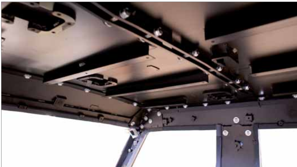
Система болтовых соединений, установленная в F7-TLC600.
